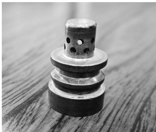
写真4 2カ所に溝のあるエアバック部品
