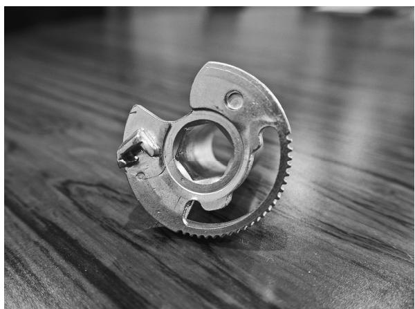
写真3 シートベルトプリテンショナー機構構成部品
